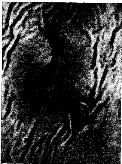
Рис. 17. Переход полосатых структур в кристаллические фибриллы в полихлоропрене
