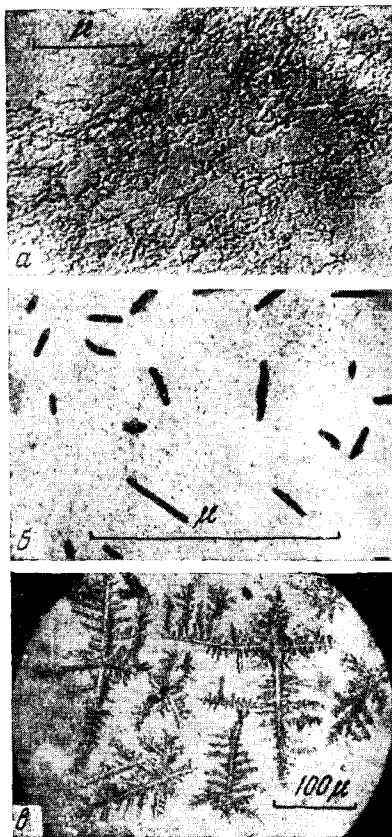
Рис. 2. Фибриллярные структуры аморфных полимеров: а — пачки натриевой соли полиакриловой кислоты, б — пачки, в — дендриты сополимера акриловой кислоты и диэтилового эфира винилфосфиновой кислоты
